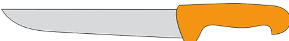
Le couteau de boucher est le plus utilisé par le personnel de la profession. Il est large et très rigide, la longueur de sa lame varie de 16 à 40cm. Ce couteau est conçu pour découper de gros morceaux de viande, briser de petits os et hacher la viande et le poisson. Il est capable de découper dans la masse du muscle grâce à son tranchant puissant.
